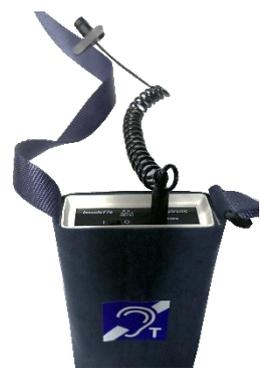
**boucleTTe Toptronic** ist ein Sender von magnetischer Strahlung, Minischleife nach EN 60118-4.
