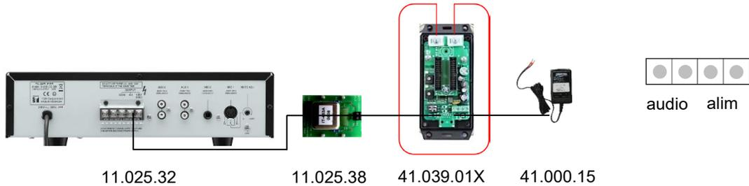
Ampli 11.025.32 : entrées 1 jack et 1 cinch DIN sortie 100 V
